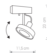
CROSS stal lakierowana / painted steel / лакированная сталь 9603 ● WH/GR 9598 ● GR/WH Ⓧ 1xGU10, ES111, max 75W
